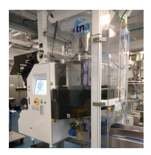
Le robag FX 3ci de **tna** a également été personnalisé avec un logiciel de produit en détection de joint (PISD) qui surveille le produit au niveau du joint et de la mâchoire. Si l'intégrité du joint est compromise, le système alerte immédiatement l'opérateur pour que les sacs soient rapidement retirés de la ligne pour une inspection supplémentaire. De cette manière, Pipers Crisps peut assurer la qualité supérieure de chaque sac tout en maintenant la quantité de gaspillage au minimum.
